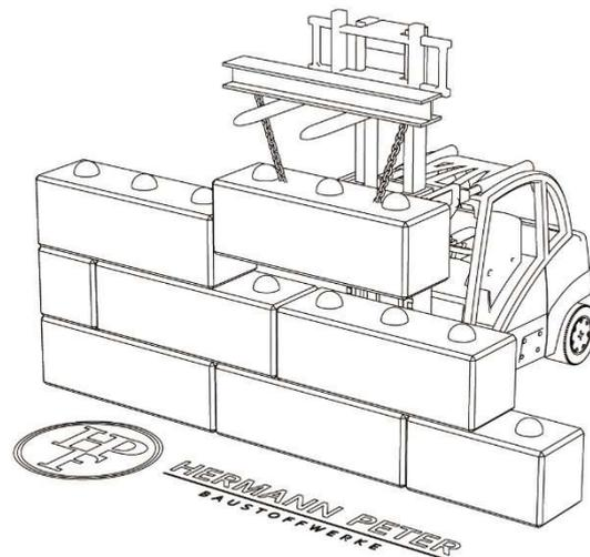
**Remarque:** en cas de déplacement, la boucle de l'anse de levage ne doit pas dépasser un angle de 45° par rapport à la surface de la pierre.
