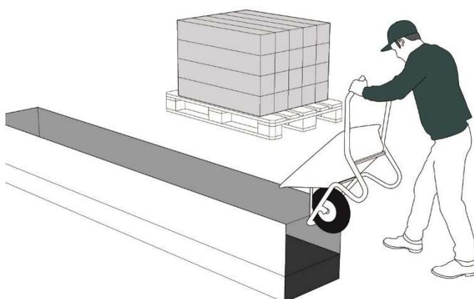
Füllen Sie eine 10 – 20 cm dicke Schicht aus Beton ein und planieren Sie diesen grob.
