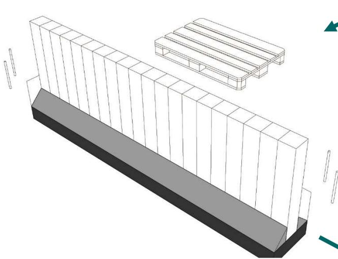
Füllen nach dem Stellen der Palisaden mit der Kelle weiteren Beton von beiden Seiten an die Palisaden. Bleiben Sie jedoch unterhalb des Bodenniveaus
