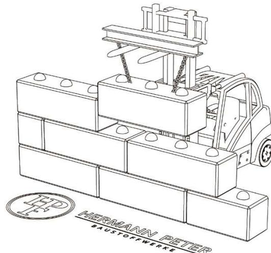
**Hinweis:** Beim Versetzen darf die Schlaufe der Gewindhülse maximal einen Winkel von 45° zur Steinoberfläche einnehmen.
