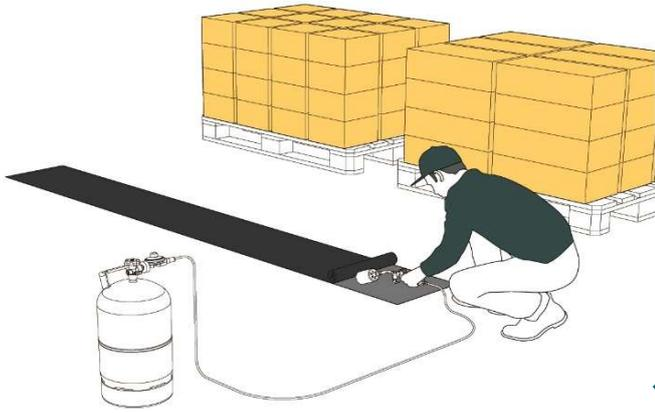
Anschließend wird die zugeschnittene Bitumenbahn auf die Grundierung gelegt und gebläht, damit die Bahn sich fest mit dem Untergrund verbindet. Die einzelnen Bahnen sollten jeweils 15 cm überlappen.
